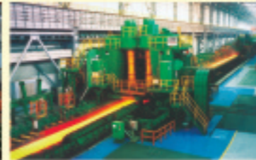
粗轧机 Roughing mill
