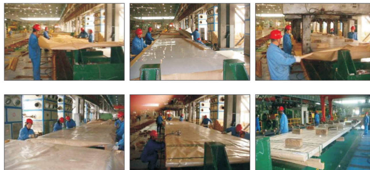
EPS生产线包装标准----板包装
