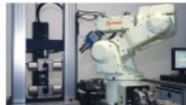
全自动电子拉伸试验机
