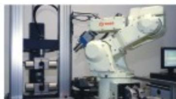
全自动电子拉伸试验机
