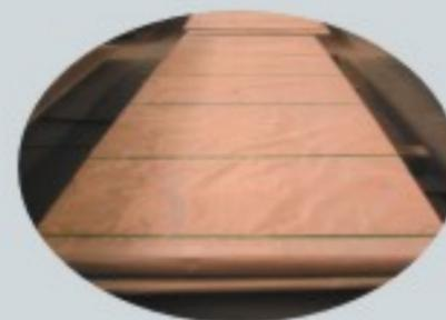
中板包装采用防水材料，加装支架防止钢板变形。
