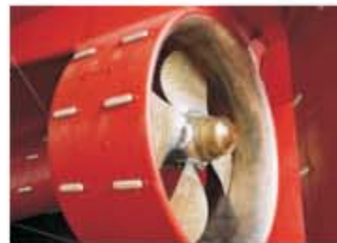
螺旋桨导流槽S32304 Guide channel of impeller
