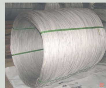
太钢料一个拔程5.5→1.1mm 进口料一个拔程5.5→1.5mm
