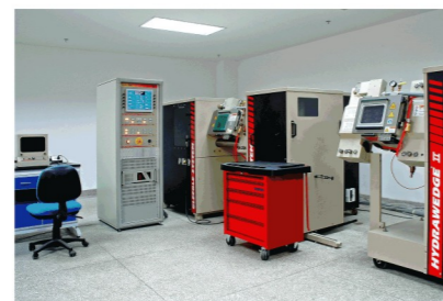
热模拟试验机 Thermal Simulating Tester
