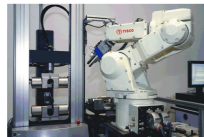
全自动电子拉伸试验机 Automatic electronic tensile tester
